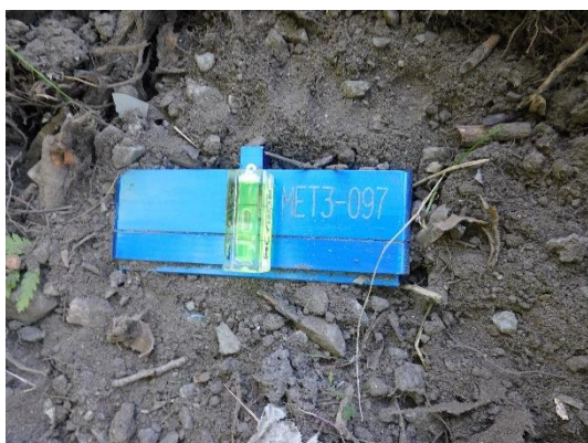
Bild 1. Placering av givare till mätpunkt 2, före jordtäckning.
