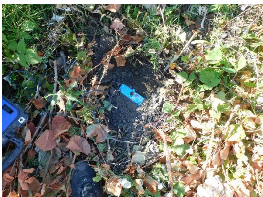
Bild 1. Placering av givare till mätpunkt 1, före jordtäckning.
